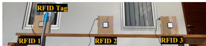
Gambar 15. Pengujian RFID Tag Posisi Kanan terhadap RFID 2 dan Posisi Kiri terhadap RFID 1
