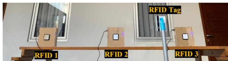
Gambar 13 Pengujian Posisi Kiri terhadap RFID 2 dan Posisi Kanan terhadap RFID 3
